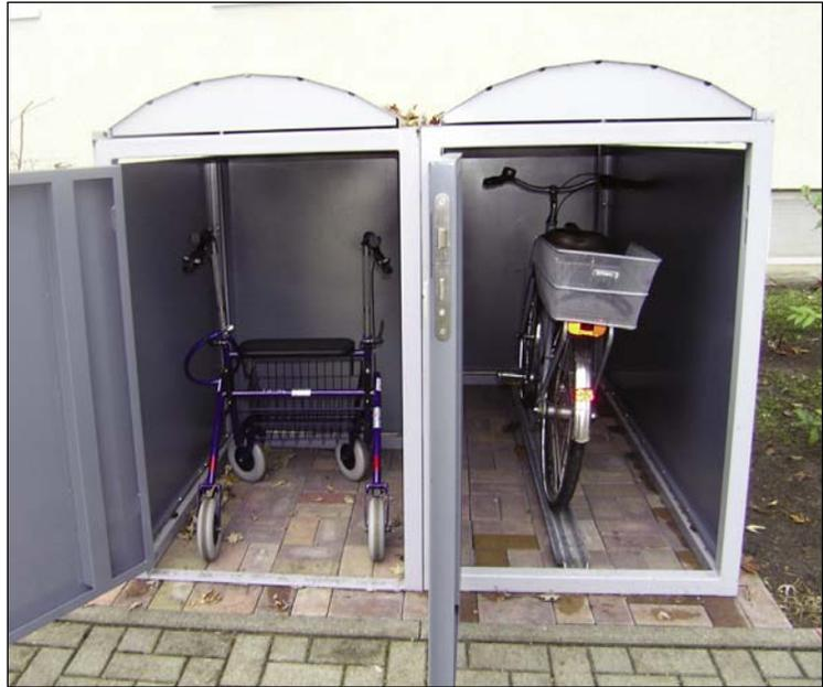
**Die Rollatorbox ist hier kombiniert mit einer Fahrradbox. Sie hat keine Schwelle, so dass ein einfaches Einschleppen möglich ist. Die Fahrradbox ist mit einer Schiene zum Einschleppen und Fixieren des Fahrrades ausgerüstet.**
