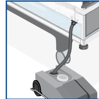
3. Der Abwasserschlauch der Matratzenwanne wird am Abwasserwagen angeschlossen.
