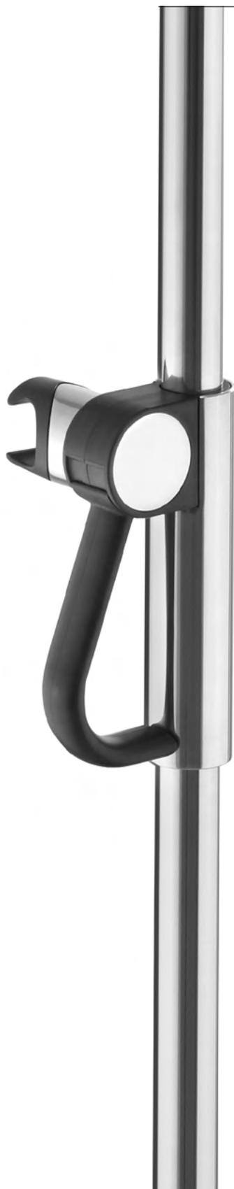
Der Brausekopfhalter ermöglicht eine komfortable Nutzung der Brause: Er vereint einen ergonomisch geformten Bügelgriff für sichere und mühelose Betätigung ohne Drehbewegung mit wartungsfreier und stufenloser Höhen- und Neigungsverstellung.
