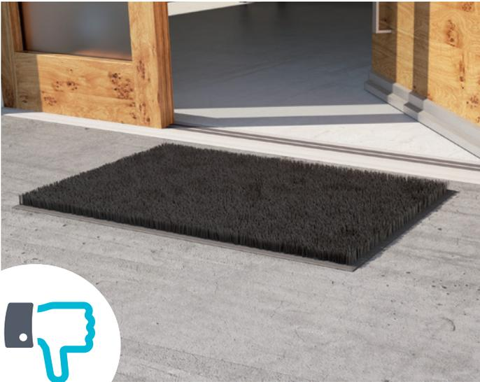
Was nutzt ein schwellenloser Hauseingang, wenn eine lose, hohe Fußmatte zum unüberwindbaren **Hindernis** oder zur Stolperfalle wird. Außerdem sind sie schwer berollbar – ob mit Trolleys, Kinderwagen, Rollator oder Rollstuhl.
